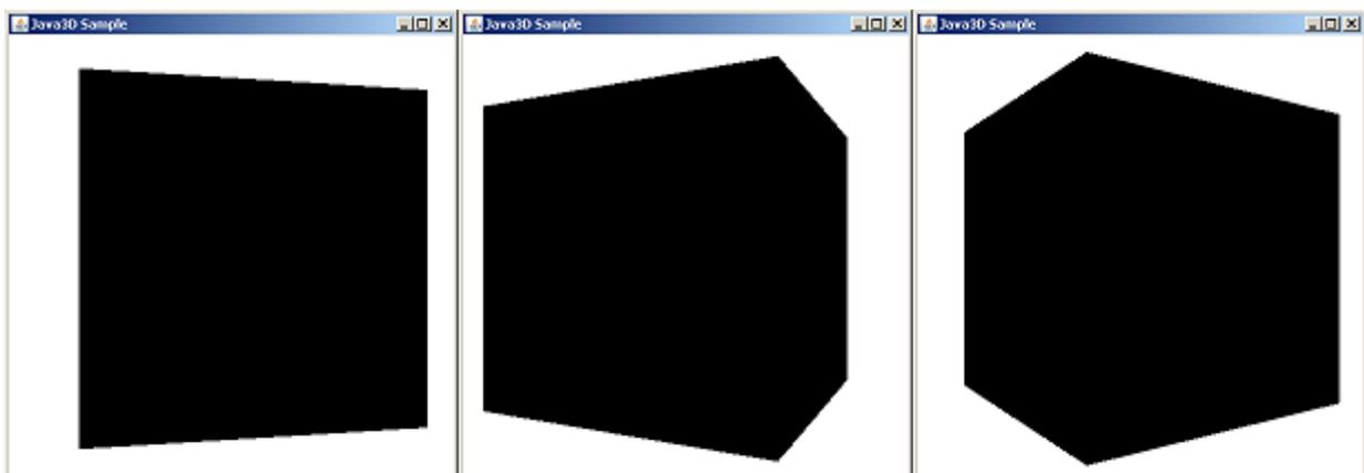
Ebbene, abbiamo ruotato il cubo. In verità non è stata una rotazione ma una rototraslazione, rispetto all'origine, o una rotazione del cubo intorno all'asse  $z = -2$ . Infatti, se osservate il codice di `create(SimpleUniverse)` o ricordate i passaggi precedenti alla rotazione, noterete come il cubo subisca uno spostamento dall'origine al punto  $(0, 0, -2)$  proprio nel metodo `create(SimpleUniverse)`:
